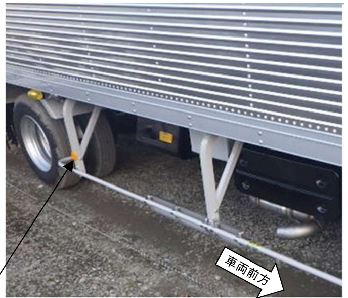
排出ガスの影響がない位置に側方反射器を移動
