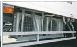
市販空調機の室外機
