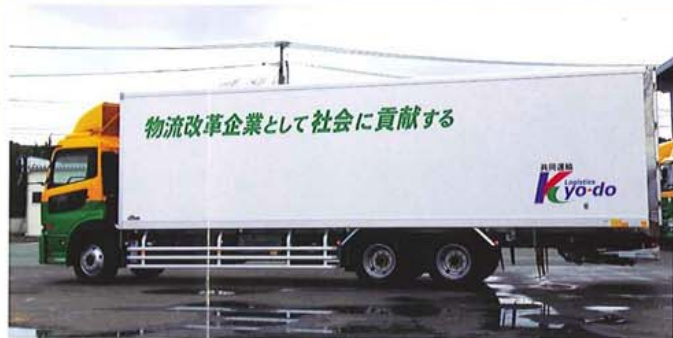
長距離運行が無いためキャブはベッドレス、その分荷室の床面積を広く取っています。
