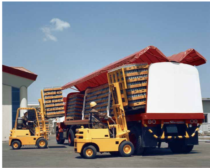
省力化のエース、日本フルハーフが開発した幌ウイングトレーラ(1969年4月)
