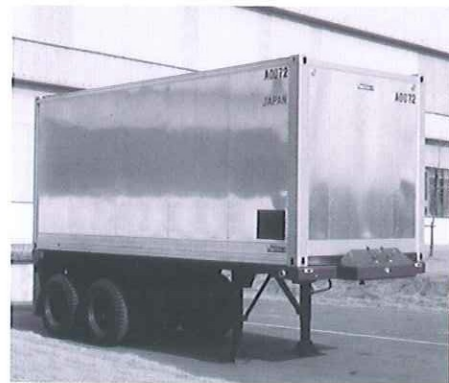
初期型シャシ・トレーラ(シーランドタイプ:コンテナをサイドのクランプで固定していた)
