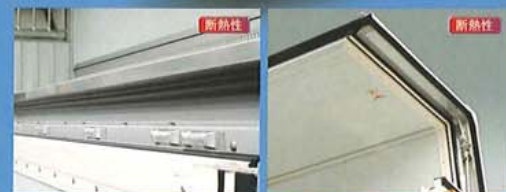
特殊2重保温シールボディにより気密性が一段と向上。開口部の断熱性が格段に向上。
