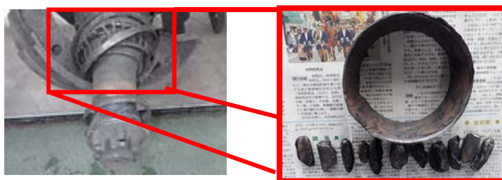
ハブ・ヘアリング破損
