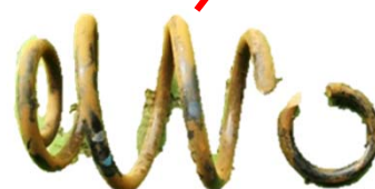
折損したメインスプリング
