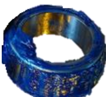
ベアリンググリスが 健全な状態
