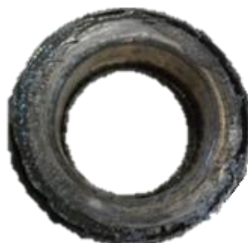
ベアリンググリスにブレーキ ダストが多量に混入
