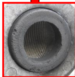
パッキンひび割れ
