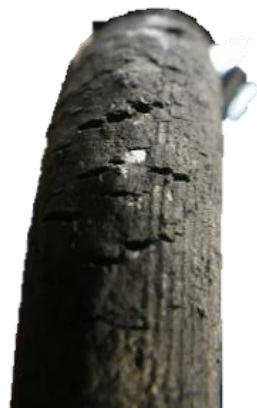
ゴム製ブレーキホースの亀裂
