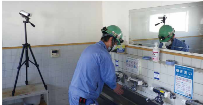
定点カメラを設置し、吐水時間を計測しています
