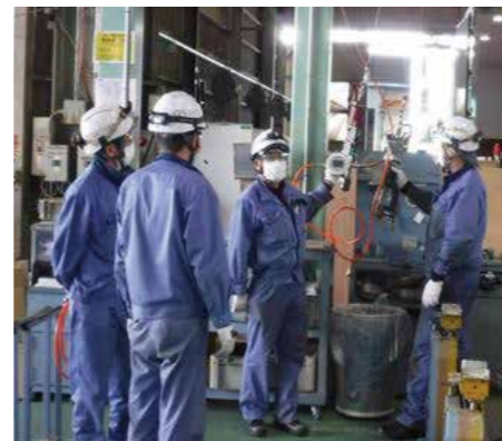
生産ラインが停止している静かな時間を利用して、漏れ箇所を確認しています
