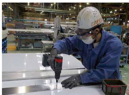
エアーツールより使い易く便利な電動工具を使い、エネルギー削減に取り組みます
