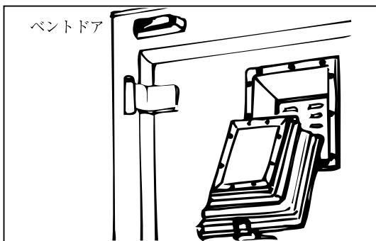
このドアは、野菜等の呼吸をする商品を輸送する場合に積荷の状況や温度、輸送時間等によりドアを開閉し温度調整をし、酸欠を防止して鮮度を保持するのに役立ちます。
