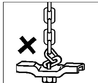
タイヤ吊上げのときはハンガのチェーンのねじれに気をつけましょう。ねじれたまま巻上げると走行中に振動でゆるみタイヤが脱落し重大な事故を引き起こします。
