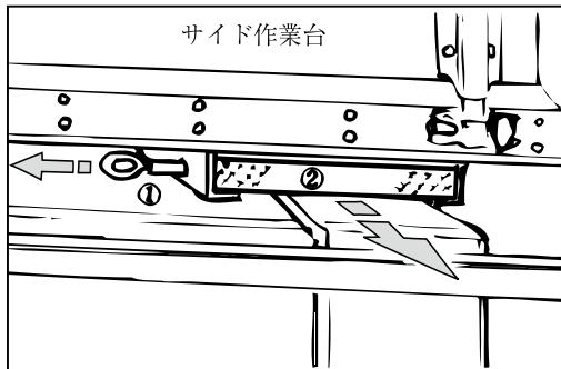
(3) バネ付落錠を作業台の基部にある受部に勘合し固定します。
