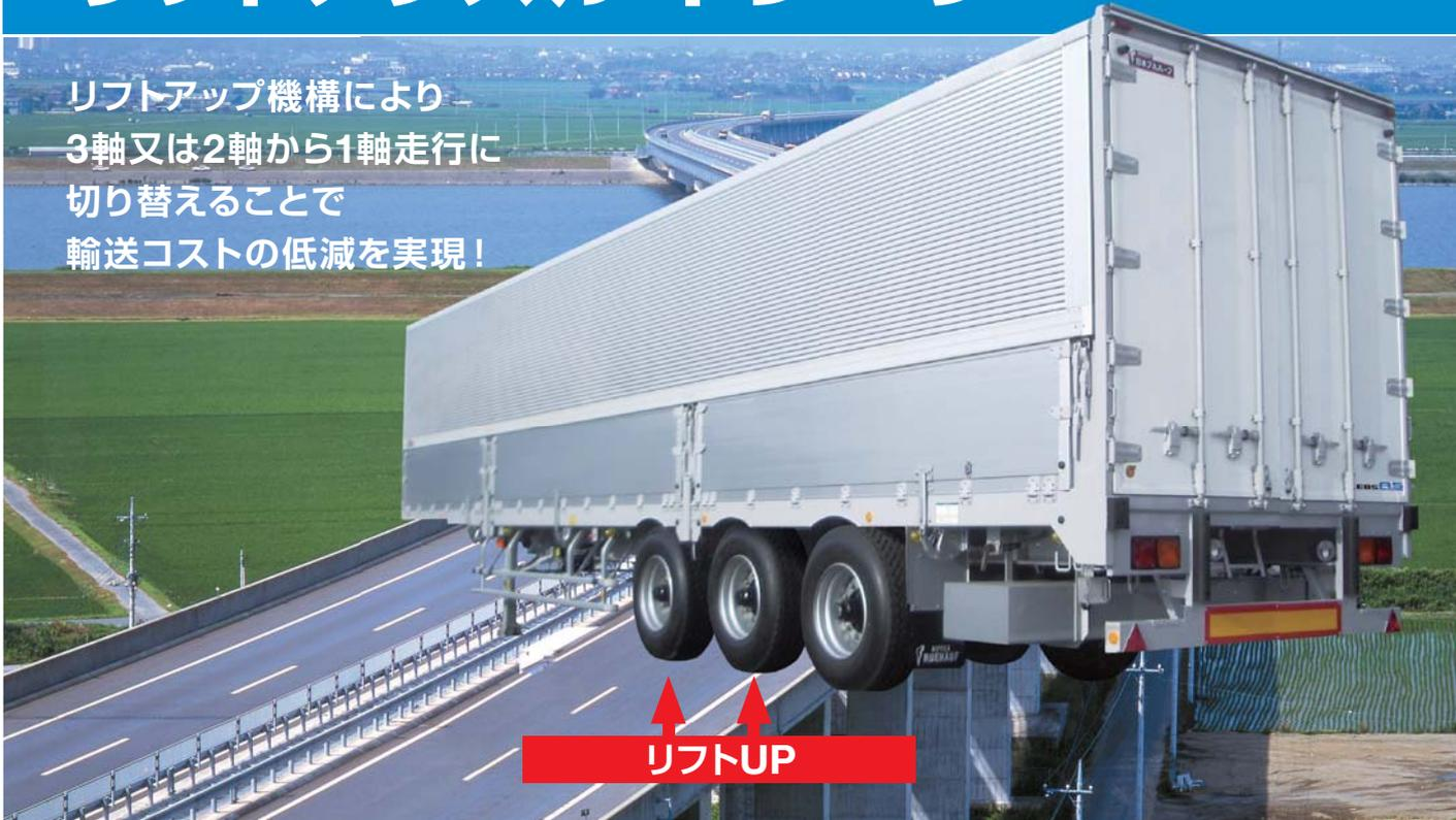
積み荷の量に応じてトレーラ後前軸(+後中軸)の車輪をリフトアップすることで、輸送コストが低減できます。
