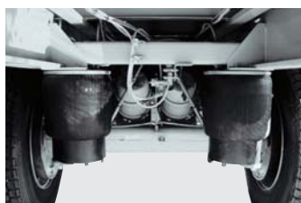
エアサスペンション 振動を低減し荷痛み荷崩れを防止、乗り心地も向上。メンテナンスも容易な軽量強靱構造。
