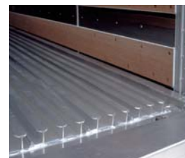
ボードフロア(全面)=アルミT型フロア ドレン50φ：フロント/リヤ各一对 <冷蔵ウィング>
