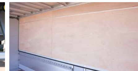
内張り (サイド耐水ベニヤ)
