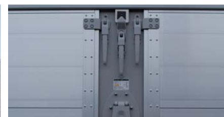
アオリロック&ウィングロック 使い易さ、頑丈さを極めた機構と形状。 (掛け金具段数はアオリ高さにより異なります)
