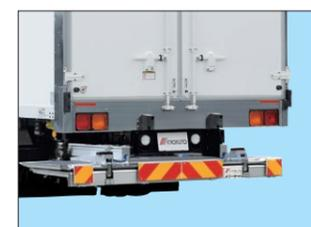
大型後部反射器取付
