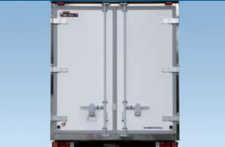
リヤドア芯材レス化 ※写真は小型車 ※一部 リヤドアSUS仕様除く
