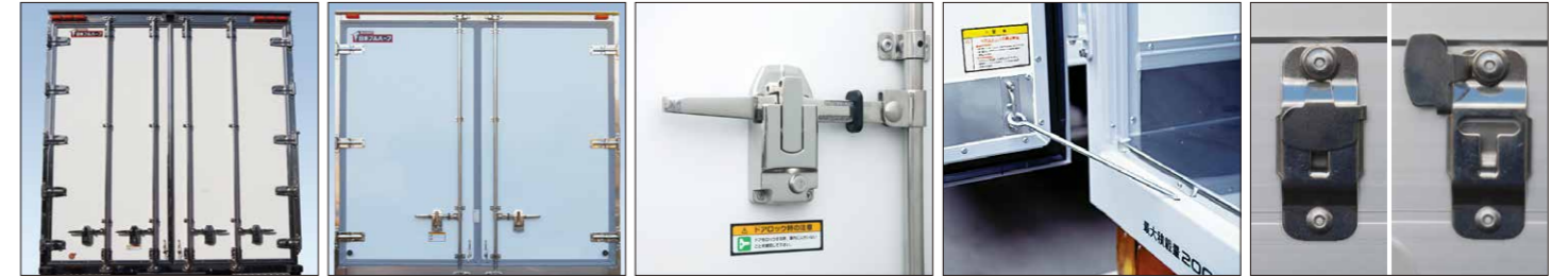
リヤ観音ドア 外板 Cr-SUS 白 ヒンジ・ロックロッド・ハンドル SUS#400 ナイスキー SUS#400 90度ストッパー 簡易式 ドアホールドバック ストッパー付
