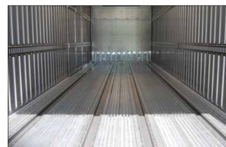
断熱材の劣化を防ぐ、継ぎ目のない ステンレスパネル リブ付き
