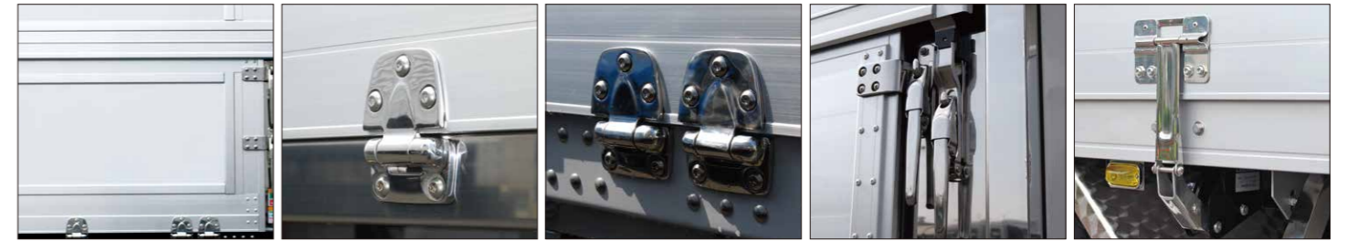
アオリSWP 外板 アルミ白 アオリ蝶番 SUS#400 アオリ蝶番追加 両端増 アオリロック SUS#400 アオリ開閉補助装置 SUS
