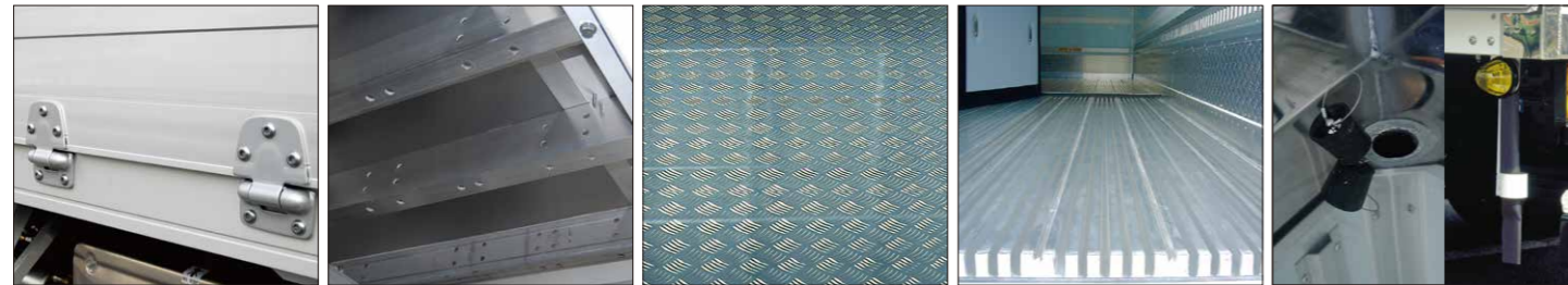
サイドレール アルミ サブフロア アルミ平板 床ライニング アルミ縞板 ボードフロア クリーンボード ドレン コック無 ゴム栓付
