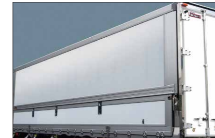
ウイング外板(フラットパネル) ウイング部を精悍に見せるリベットカバーを採用。
