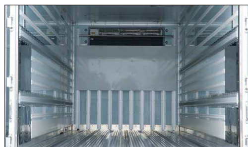
庫内 (内張りサイド:樹脂エアリブ)
