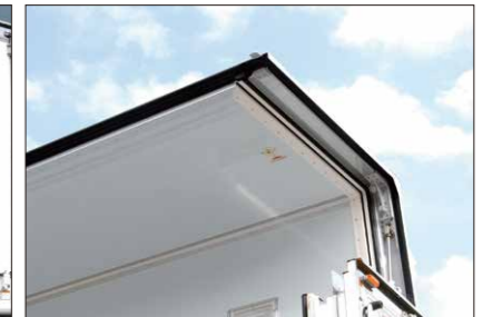
開口部に樹脂材を採用し、断熱性が格段に向上。
