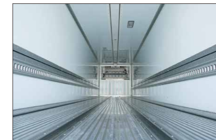
床保冷はサンドイッチパネルを採用し、木材レス化。
