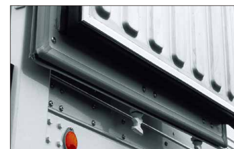
気密性抜群の2段リップ式ガスケット
