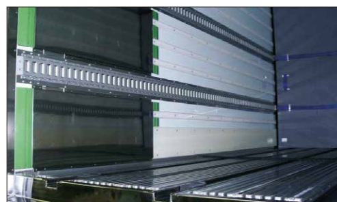
床下合板の廃止など軽量化。 オプションのジョロダールールやクリーンボードも軽量化しました。
