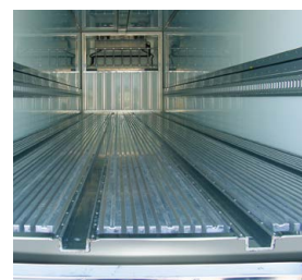
搬送装置床レール
