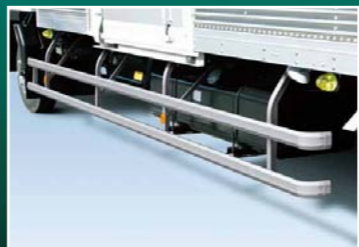
サイドバンパー 角型2段(アルミ製)を採用しています。
