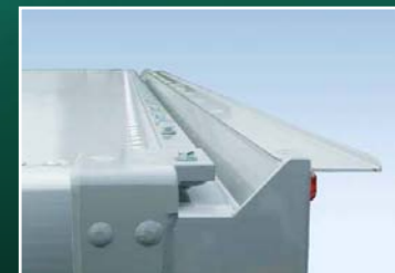
リヤフレームヘッダーコーナー部 リヤフレームの上部をルーフパネルより高い 位置へ設置し、開口高を拡大。 さらに雨水を溝によりサイドに流すことで、リヤ ドア開閉時の庫内への巻き込みを防ぎます。
