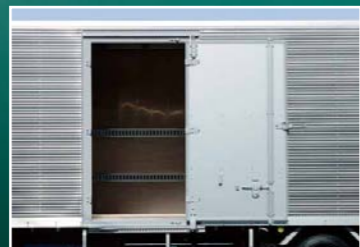
サイドスライドドア(オプション) 内法幅を大幅に拡大する薄型サイドドア。庫内 容積をしっかりと確保し、より積載性を高めます。
