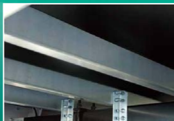
クロスメンバー 軽量かつ強靱なアルミ製クロスメンバーを 採用。
