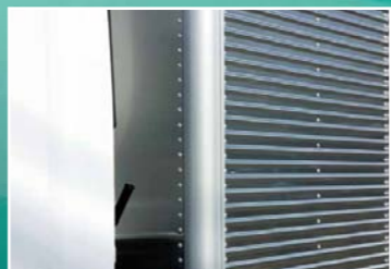
フロントコーナーポスト 50Rのポストを使用。キャブ段差50～ 100mmでもプロテクタの必要はありません。
