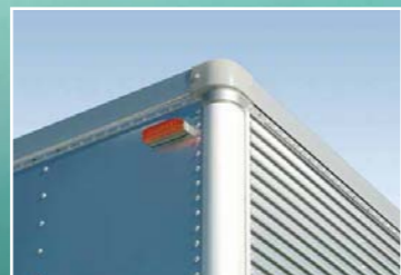
フロントトップコーナー部 トップマーカーランプ 消費電力の小さいLEDを採用しています。
