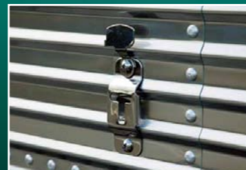
リヤドアホールバック(フタ付) 開いたリヤドアを確実に固定し、強風時も 荷役作業の安全を確保します。
