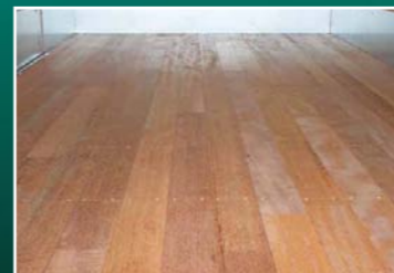
床/内張り 床板はアビトン材、アカンアラミネット等を豊 富にご用意。内張りは、経済的で交換可能な ベニヤを使用しています。
