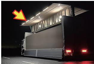
アシストルームランプ 羽根内側下端取付
