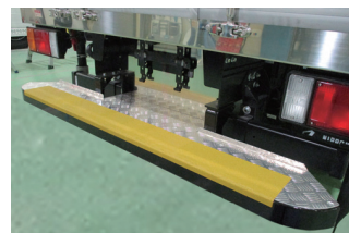
リヤバンパー (チャンネル) h=60 アルミ編板張り+滑り止めテープ
