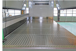
床ライニング (全面) アルミ縞鋼板 t=2.5
