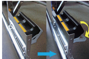
車輪止め（スプリング式） ※取り付けプレートはバンパーの仕様で変わります。標準は鉄製。
