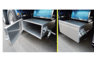
リング格納庫 ROH BOX& 蓋アルミ平板
