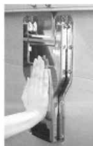
③スライダーの上がりど爪の掛かりを確認する
