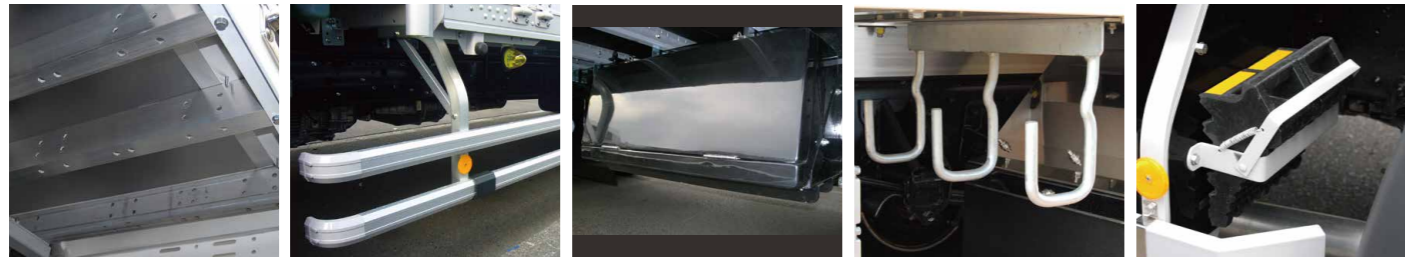
サブフロア アルミ平板 サイドバンパー ※MWS,MWC 工具箱 ※MWS,MWC チェーン掛け ※MWS,MWC 車輪止め スプリング式
