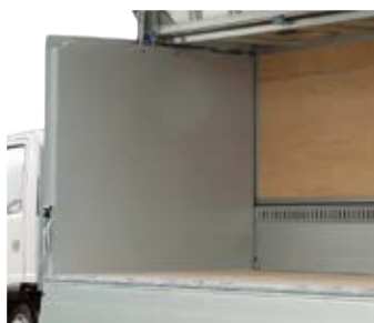
フロント内板 垂鉛鉄板
