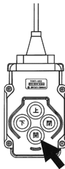
スイッチボックス内ペンダント スイッチでの操作
