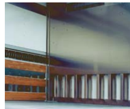
リターンエアガイド バルクヘッド式冷蔵ウイング>
