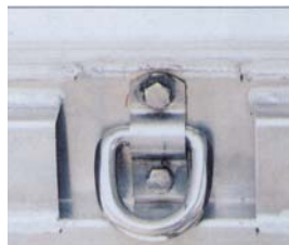
埋込床フック(馬蹄形SUS製) <冷蔵ウイング>
