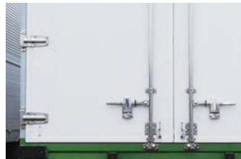
SUS製ドア金具 (ヒンジ・ロックロッド・ハンドル)
