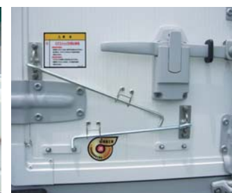
リアドア180度ストッパー(オプション) ※リアドアストッパーは90度または180度から選択できます。
