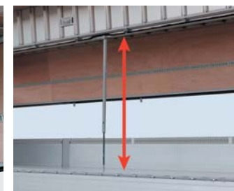
ルーフの昇降に合わせて、センターポストを伸縮できます。
