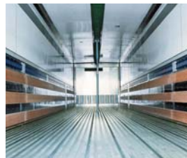
内張り：FRP合板 6.3t (フロント/サイド/ルーフ/リヤ) <冷蔵ウイング>
