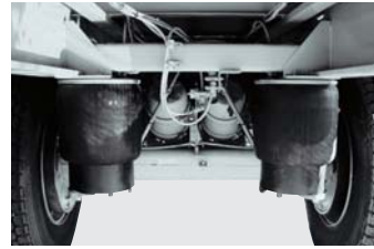
エアサスペンション 振動を低減し荷崩れを防止、乗り心地も向上。メンテナンスも容易な軽量強靱構造。
