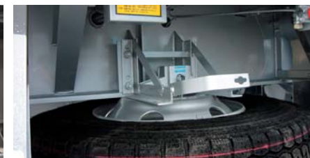
スペアタイヤキャリア&スペアタイヤ (写真はホイールベース間左側取付)
