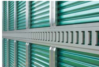
ラッシングレール (ウイング部ポスト段押し加工)
