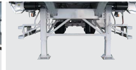
ランディングギヤ 操作スピードの2段切り換えができ、軽くスピーディな操作が可能。
